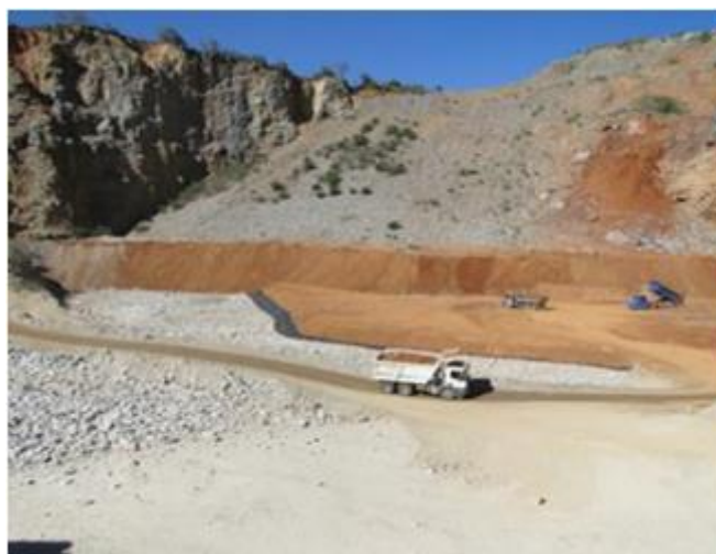
Figura 2-2 - Disposição do estéril no fundo da cava
