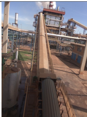
Figura - Esteira de caminhamento do bagaço resultante da moagem
