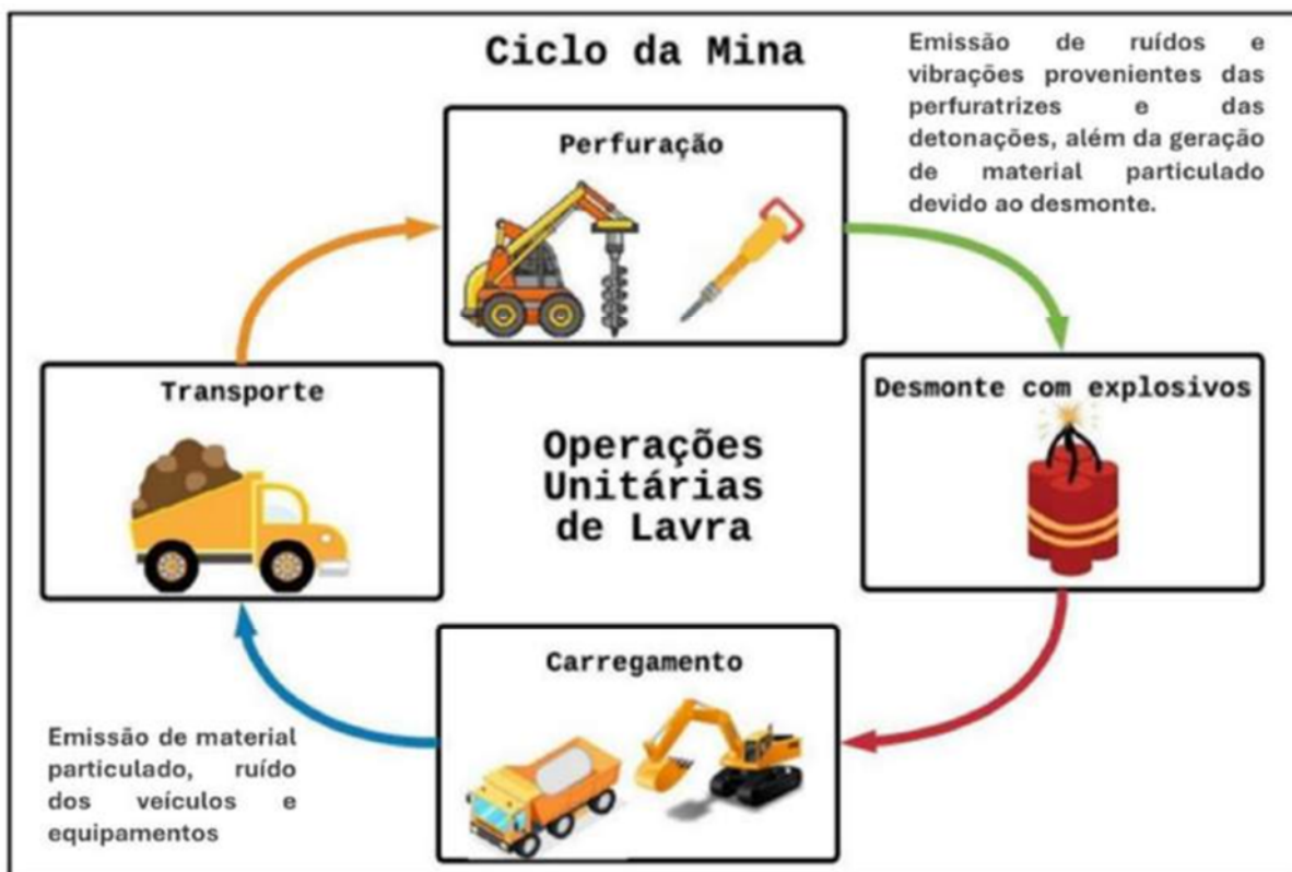
Figura 03: Ciclo do processo produtivo de uma lavra. Fonte: RCA, 2024
