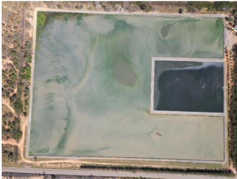
Foto 03: Vista aérea das lagoas: menor anaeróbica (interna) e maior facultativa
