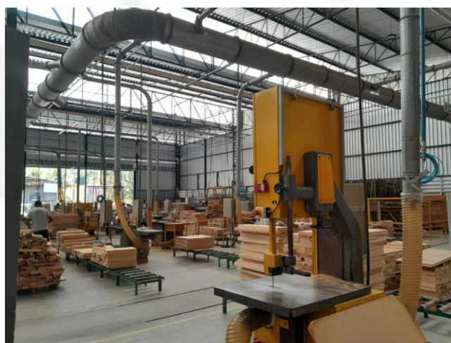
Figura 04: Setor de corte de madeira contemplado com sistema de exaustão para a coleta de material particulado.
