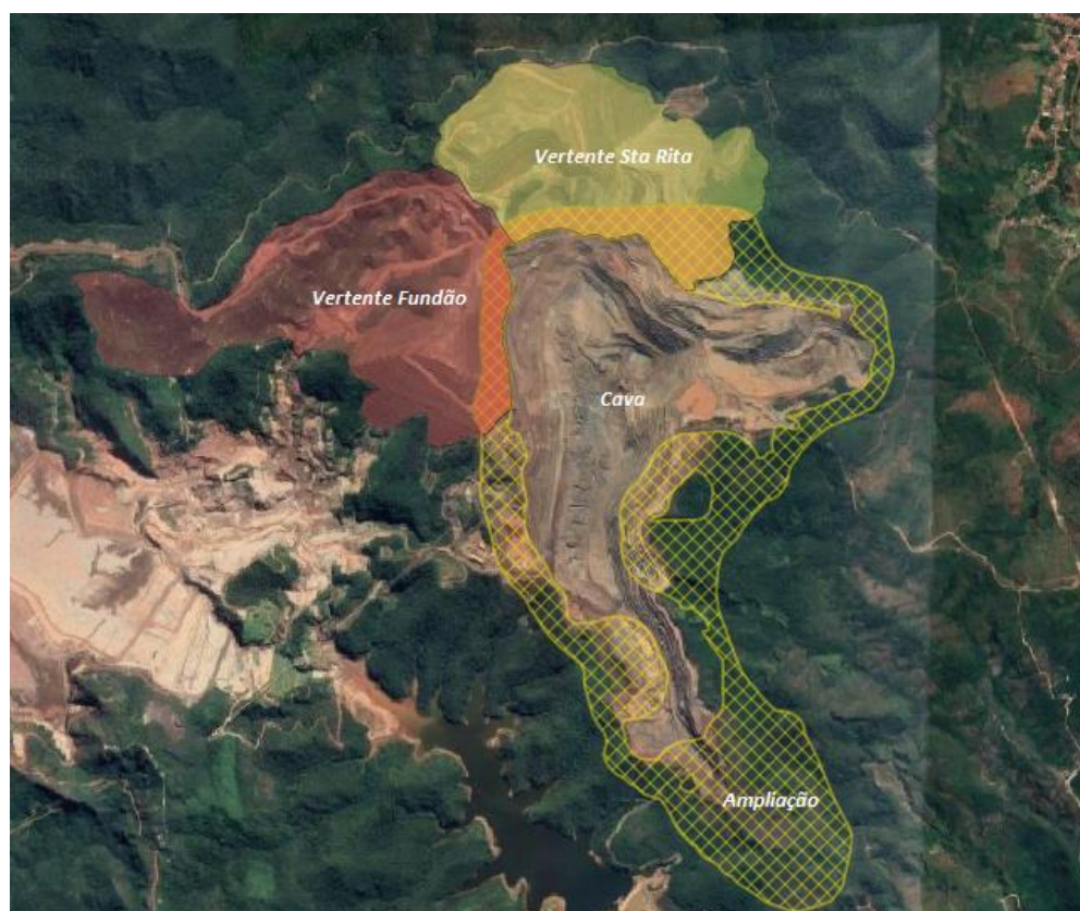
Figura 2.5 - Subdivisão PDE União (Vertente Fundão e Vertente Santa Rita), Cava atual e Cava Ampliação. Fonte: Google Earth 2020.
