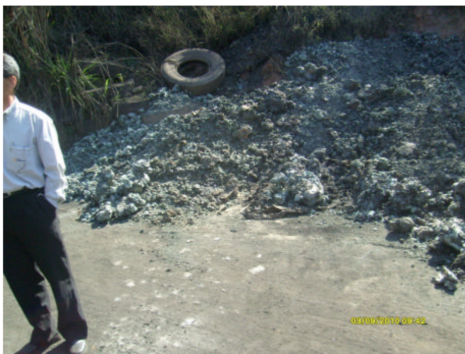
Imagem 04: armazenamento inadequado de areia de fundição.
