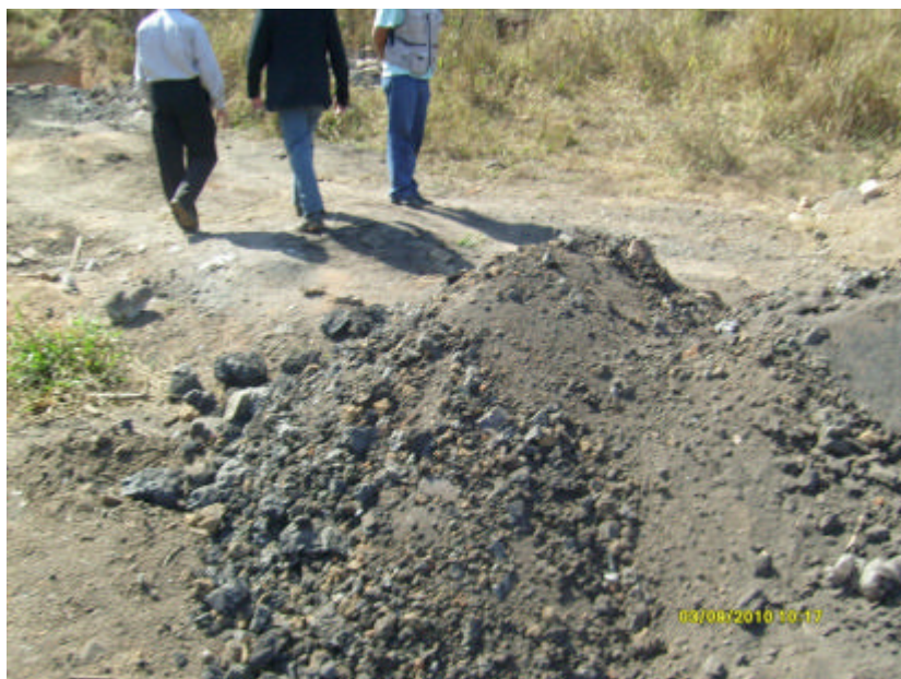
Imagem 06: Armazenamento inadequado de escória
