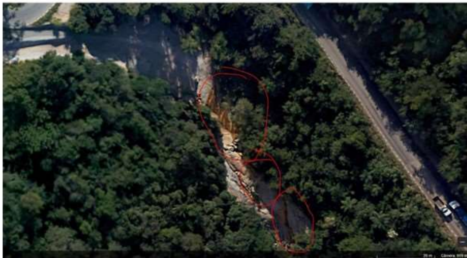
Figura 2. Vista área do início do canal de possível vertimento do chorume, Aterro de Macaúbas - Sabará/MG.
