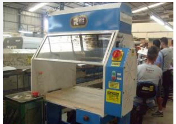
Foto 04 - Cabine onde é realizada a aplicação de halogênio
