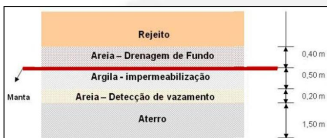
Figura 08 – Sistema de impermeabilização e detecção de vazamento atual.
