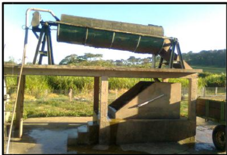
- Peneira rotativa (retenção do sólido)
