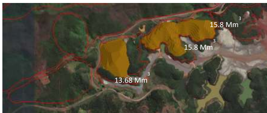
Figura 7 – Arranjo ilustrativo da formação das pilhas
