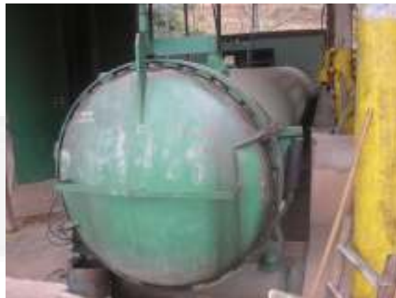
Foto 02. Autoclave utilizada para aplicação da solução de tratamento
