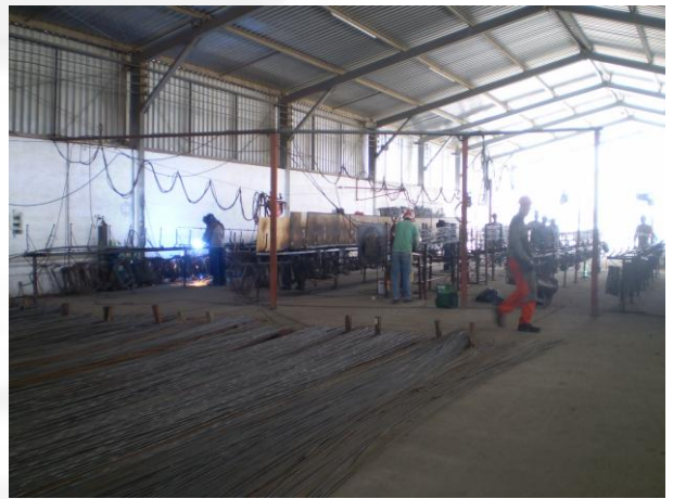
Foto 10. Local de produção das armações de aço
