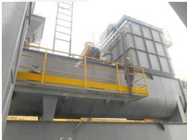
Foto 03. Reator para mistura da cal com água (hidratação).
