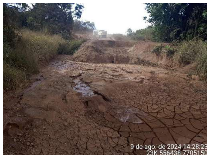
Foto 14: Estéril argiloso depositado em sump , proveniente do filtro-prensa.
