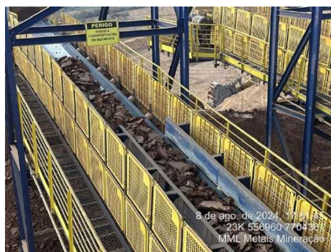
Foto 26: Correia transportadora direcionando o estéril que sai das placas de filtragem para a pilha temporária.
