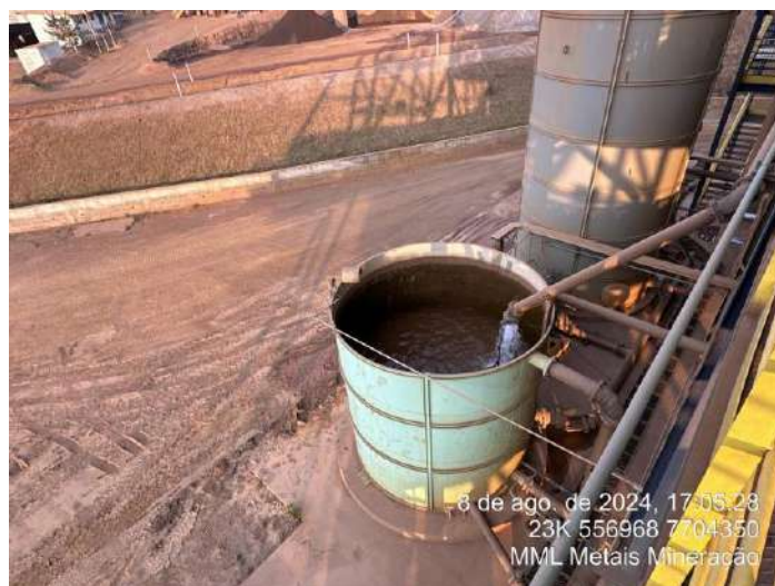
Foto 28: Tanque que recebe a água de processo retirada no filtro-prensa.
