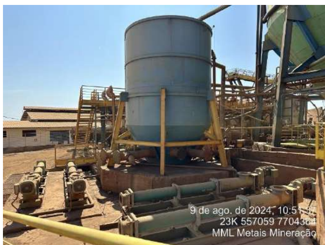
Foto 7: Um dos tanques que recebe os efluentes advindos da UTM, antes de serem direcionados aos ciclones.
