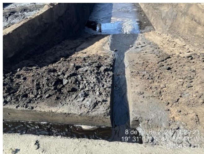
Foto 44: Efluente do lavador de gás desaguando no tanque de pó de balão
