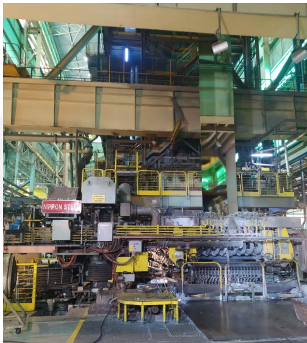
Foto 02: Saída da tira do pote de zinco e entrada no forno Galvaneeling.
