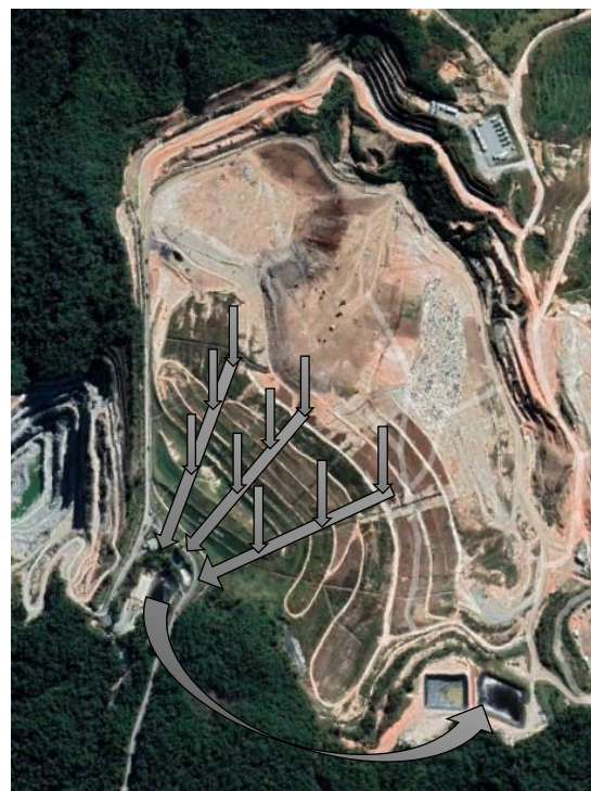
FIGURA 26 – Figura esquemática do encaminhamento do chorume
