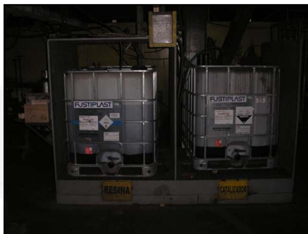
Foto 02. Matéria-prima para formação dos moldes (resina e catalisador)
