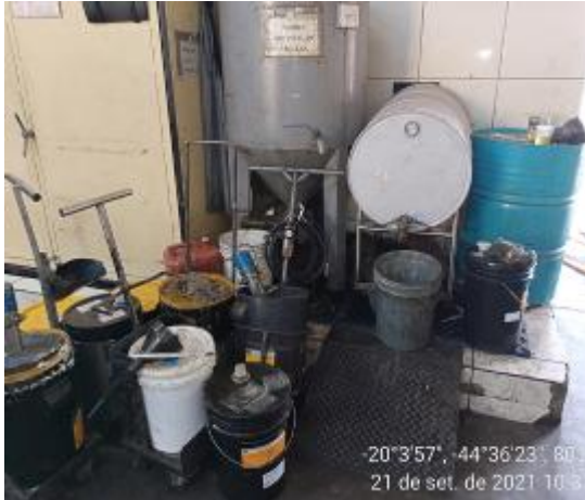
Foto 07. Armazenamento e manuseio de resíduos oleosos e contaminados
