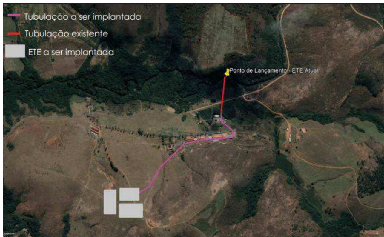
Figura 02: Tubulação para lançamento dos efluentes tratados no rio das Mortes.
