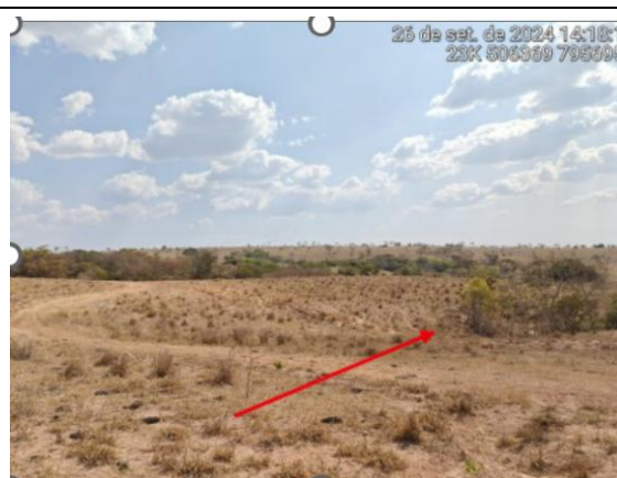
Foto 6: Ponto de Verificação 75 – Alternativa locacional menos impactante ("pseudo-estrada"), que se fosse considerada no projeto, evitaria a supressão da vegetação da Mata Ciliar (seta vermelha) para instalação do acesso.
