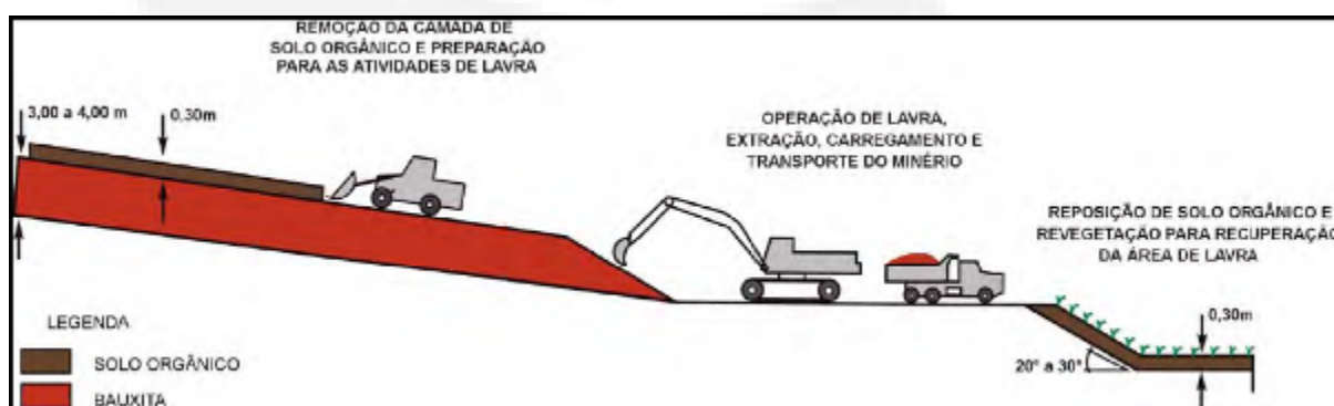
FIGURA 4 – Fluxograma das atividades minerárias da CGM. Fonte: RADA revisado.
