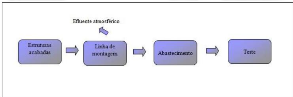
Figura 03: Fluxograma do processo produtivo do galpão de montagem e ponto de emissões atmosféricas. Fonte: RADA
