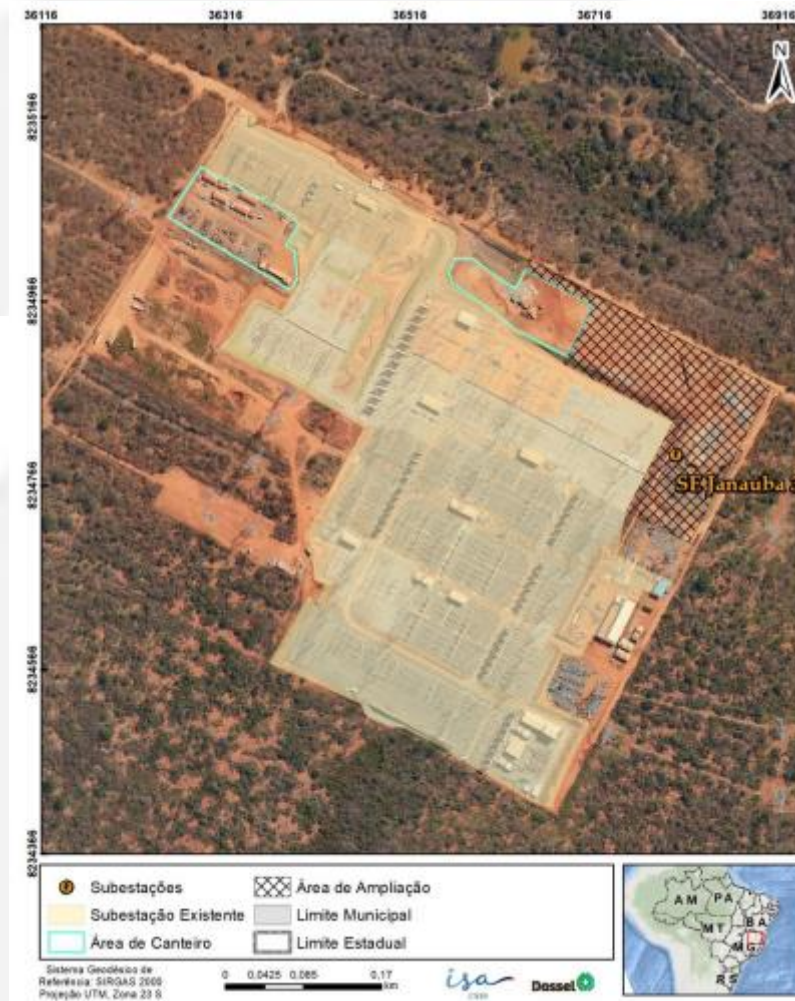
Figura 6 - Planta esquemática de situação da ampliação da SE Janaúba 3, com a indicação das principais estruturas e unidades de apoio às obras. Fonte: RT Situação/Doc SEI 75224304
