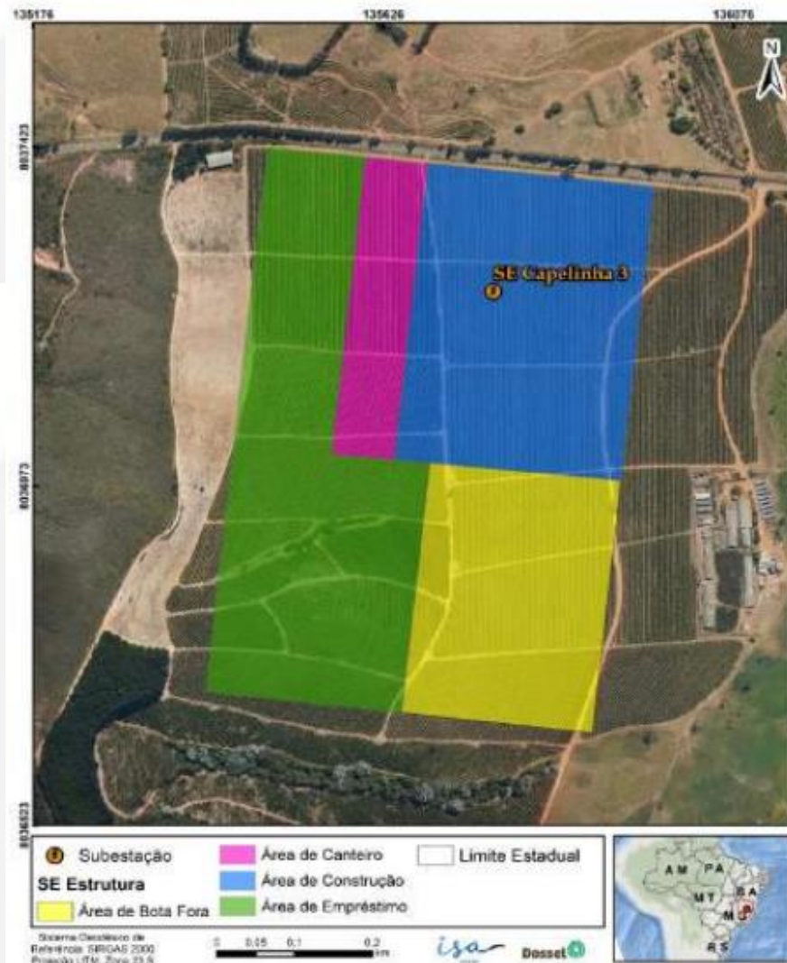
Figura 8 - Planta esquemática de situação da SE Capelinha 3, com a indicação das principais estruturas e unidades de apoio às obras de implantação. Fonte: RT Situação/Doc SEI 75224307
