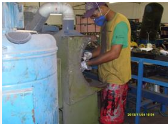
Foto 12: Lixadeira com compartimento de despoejamento.
