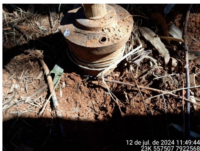
Foto 106: Tubo de monitoramento estático do poço 02. Durante a vistoria estava aberto.
