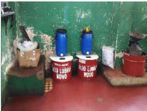
FOTO 11 – Bacias de contenção de óleo.
