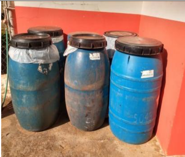
1 – Armazenamento temporário de resíduos classe I
