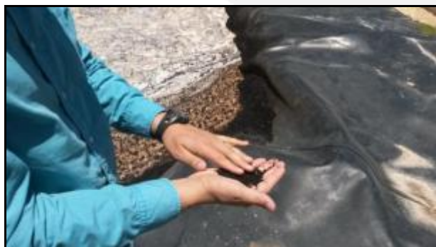
Aspecto do lodo gerado na ETE
