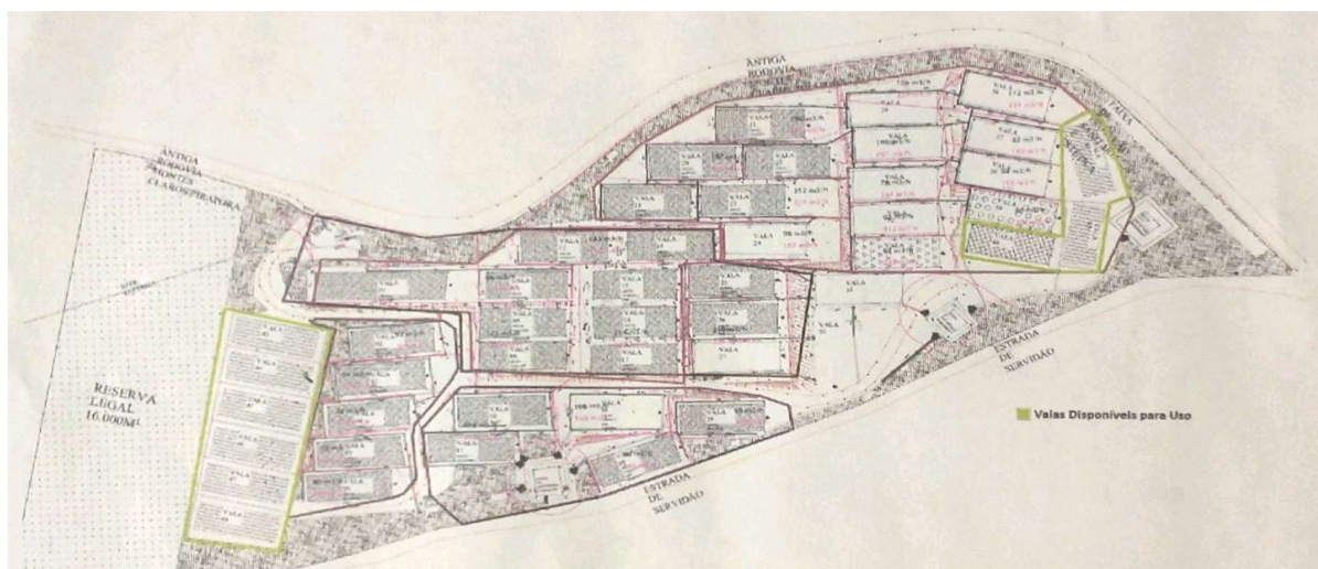
Figura 01: Layout do aterro com demonstrativo das valas aptas para uso.
