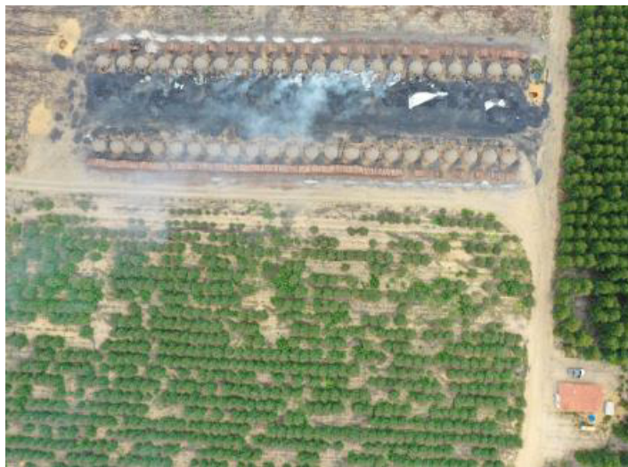
Foto 3 - Praça de Carbonização.
