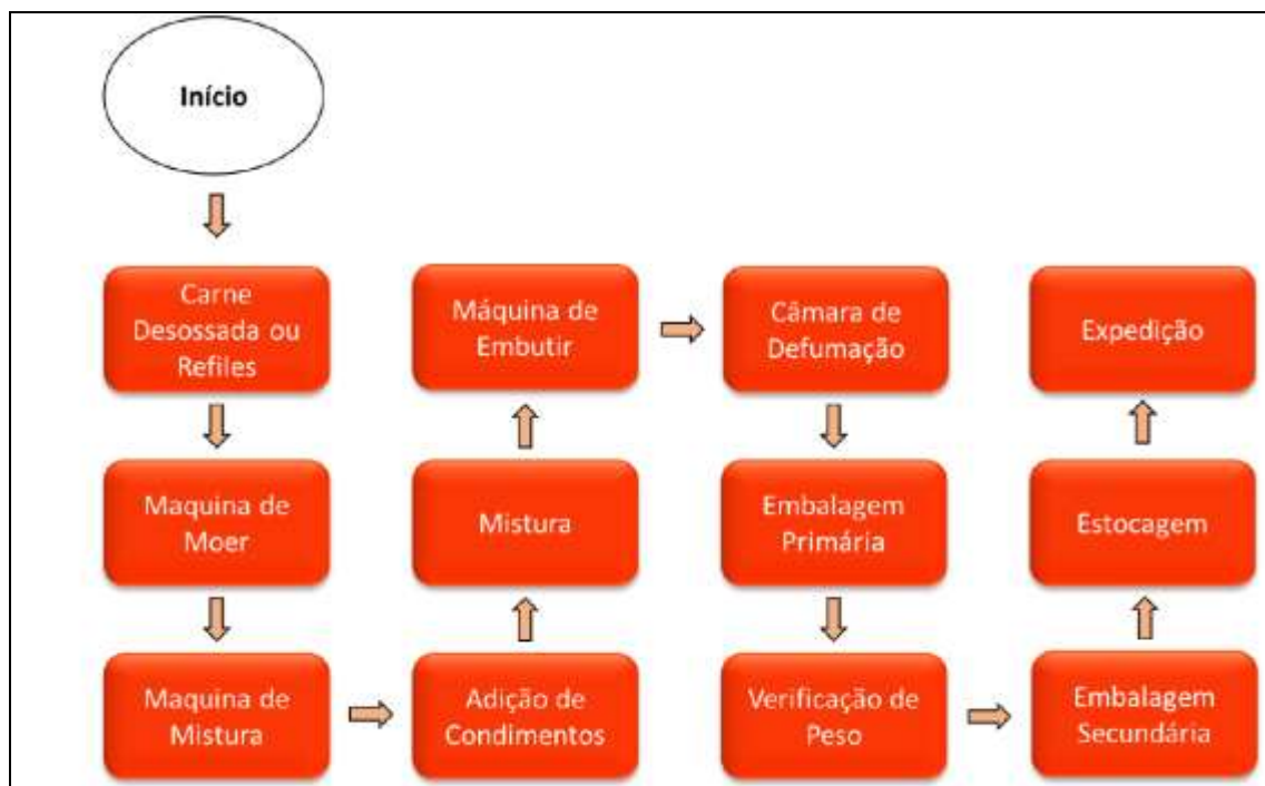
Figura 08: Fluxograma do processo de fabricação de linguiça defumada
