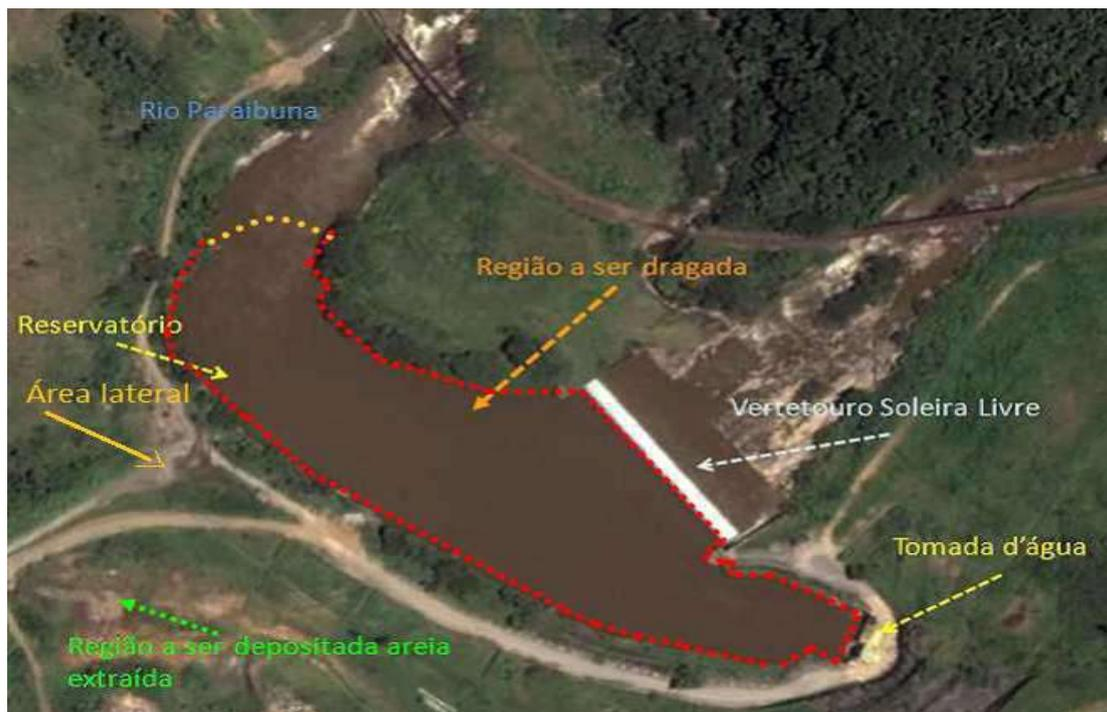
Assim, conforme consta do RADA, o procedimento será realizado no reservatório conforme ilustra a foto anterior, através de draga de sucção e recalque embarcada, onde o material extraído será depositado em praça localizada a 200 metros do reservatório, com sistema de drenagem e uma bacia de decantação adjacente e retornará a água ao rio por meio de drenos já existentes.
