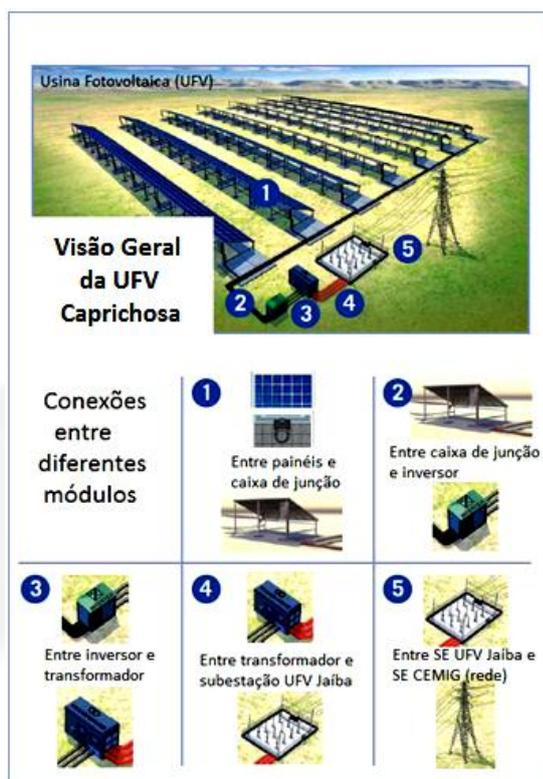
Figura 2 – Estruturas de conexão a serem adotadas na UFV Caprichosa
