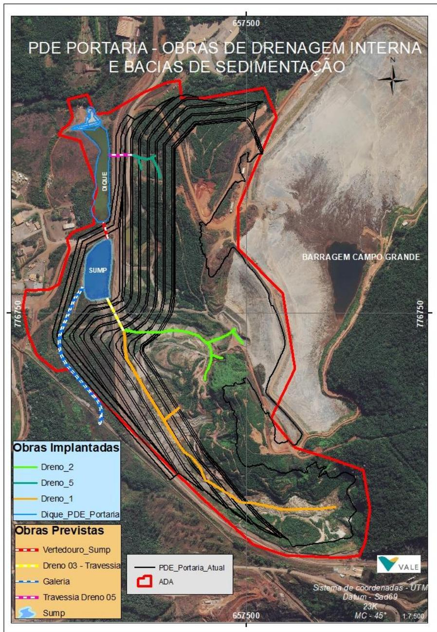
Figura 7.1: Estruturas de drenagem da PDE Portaria
