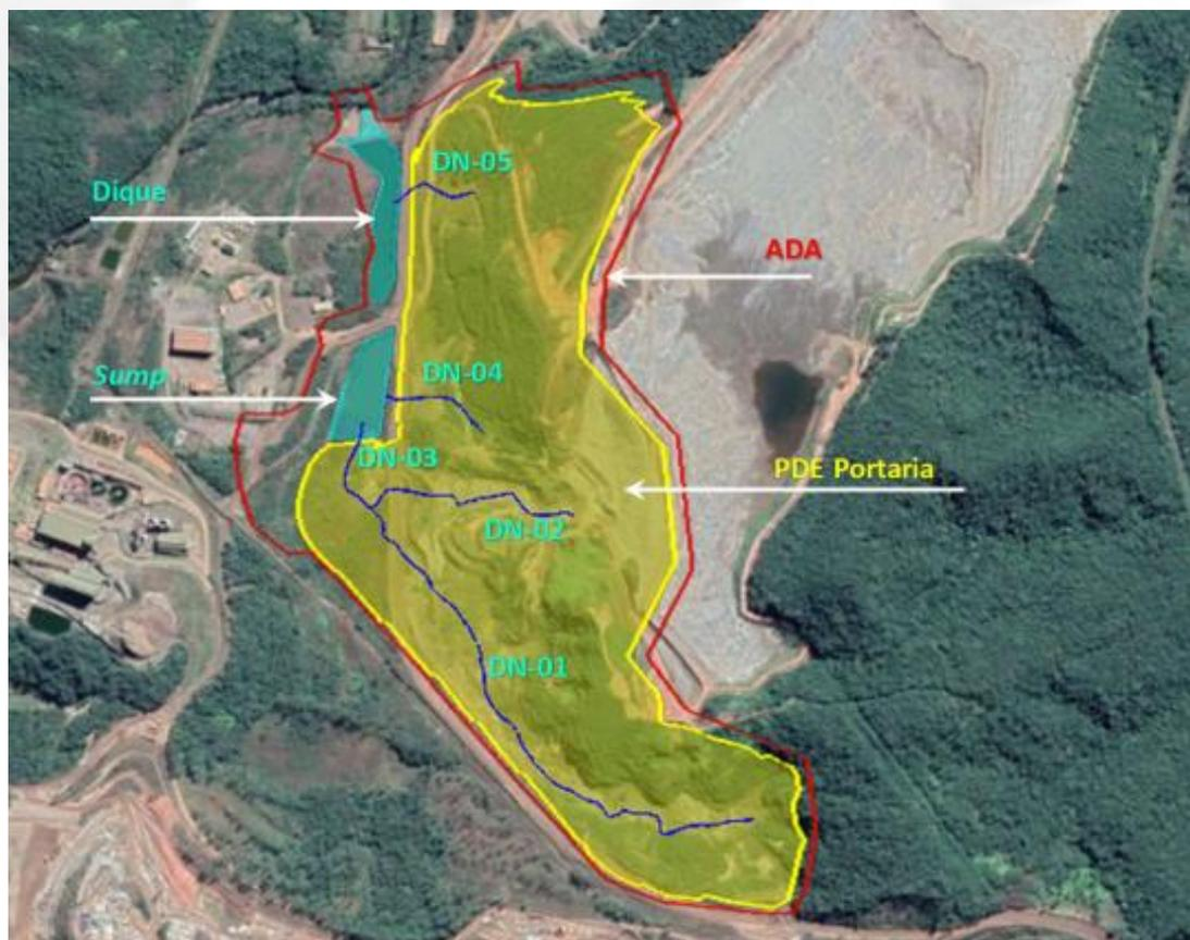
**Figura 3.2.1: Estruturas de Drenagem da PDE Portaria**
