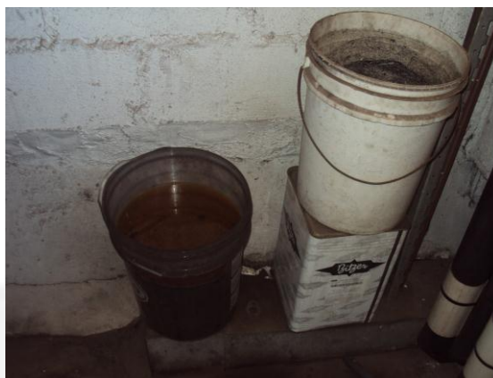
Foto 14. Armazenamento inadequado de óleo
