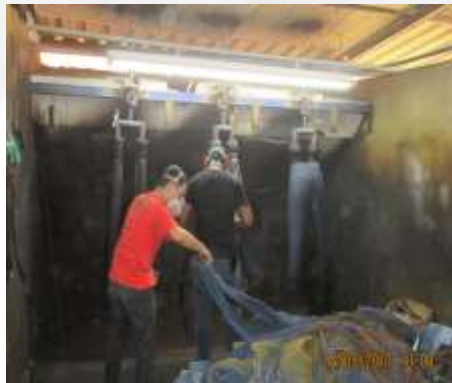
Figura 01: Cabine de aplicação de permanganato
