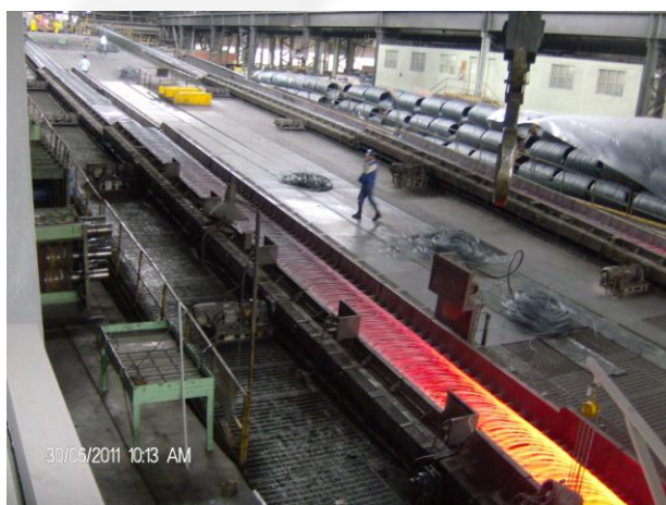
Foto 03. Produção de Fio Máquina (espiras).
