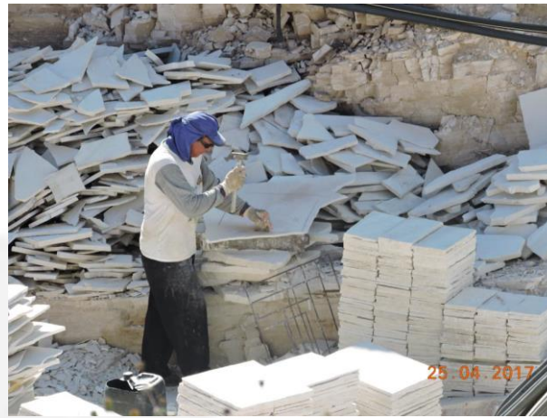
Foto 02. Print de imagem apresentada nos estudos, referente à operação de corte manual.
