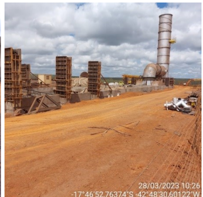
Fotos 16, 17 e 18 – Forno FAP 2000 e queimador de gases na UPER Chácara.
