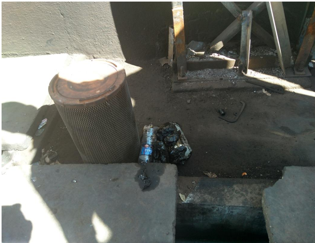
Imagem 4 – Disposição inadequada dos resíduos classe I contaminados com óleo
