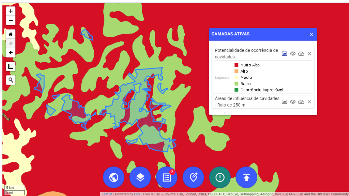
Figura-8. Mapa de Potencialidade de ocorrência de cavidades, conforme dados oficiais do CECAV-ICMBio. O empreendimento sobrepõe áreas de de muito alto grau de ocorrência de cavidades. Fonte: IDE-Sisema, novembro de 2011.
