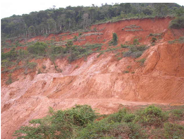
Foto 03 e 04: Decapeamento da Lavra Subterrânea, taludes desestabilizados.
