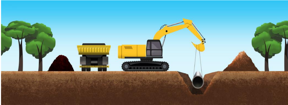
Figura 7: Ilustração da instalação de um duto e sua faixa de servidão. (Fonte: RIMA – Gasmig, 2021).
