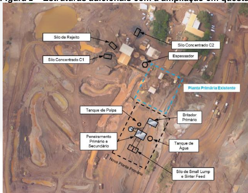
Figura 2 – Estruturas adicionais com a ampliação em questão
