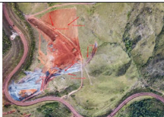
Figura 8: Terraplagem e supressão realizados para abertura da cava
