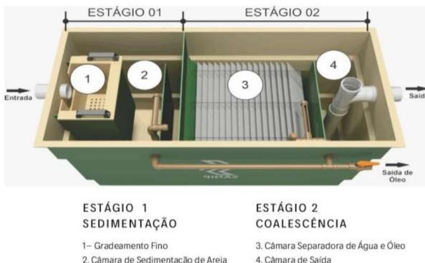
**Figura 12** – Modelo de CSAO a ser instalada no empreendimento. Fonte: Projeto Técnico do Sistemas de Controle de Efluentes Oleosos.
