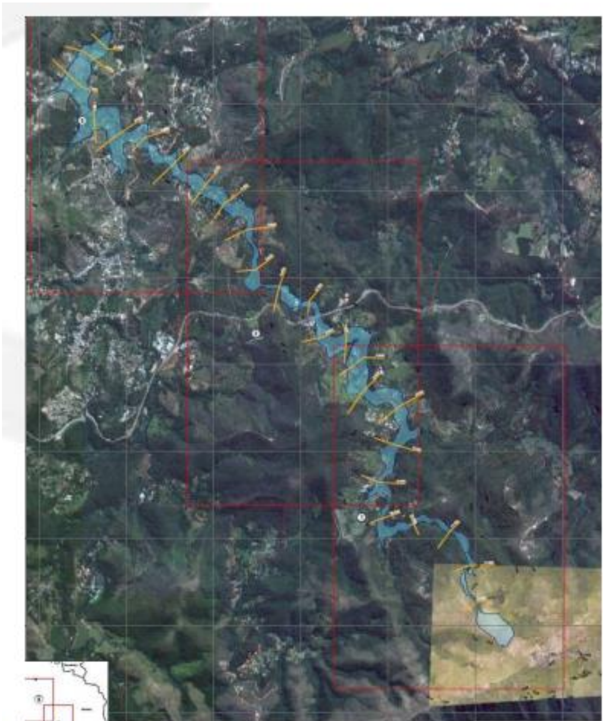
Figura 1: Área máxima de inundação caso a Pilha P1 venha a romper Fonte: ESTUDO DE DAM-BREAK PILHA P1 elaborado pela Geomil Serviços de Mineração
